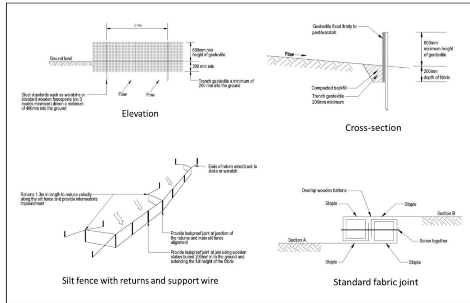
**TYPICAL DETAIL B - SILT FENCE**
