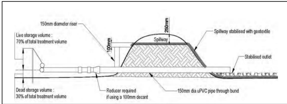
**TYPICAL DETAIL A - DECANTING EARTH BUND CROSS SECTION**
